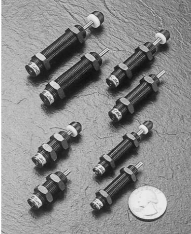
M8、M10為單孔固定式設計，M12為多孔固定式設計；輕負荷高效率之微小型油壓緩衝器，能夠將快速移動之機件有效平穩地瞬間停止。
