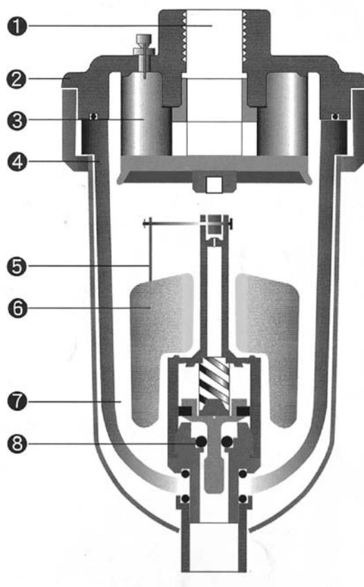
MAD500(M)為高品質而價廉物美的氣壓控制產品，可多量按裝於空壓系統的後段，以清除排放過濾器、乾燥機、管路上積存之水份，其優良品質與堅固耐用更優於傳統排水器，其特性如下：
